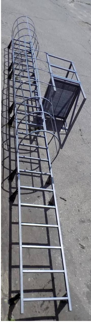
Полная проверочная сборка лестницы демонстратора в заводских условиях
